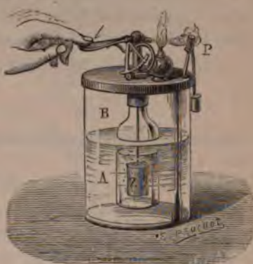
Fig. 18. — Briquet à hydrogène.
